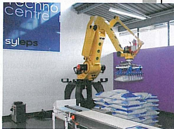
Le robot palettiseur de sac qui est en démonstration permanente au Technocentre
