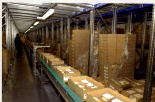
Picking. Le prélèvement des colis est effectué directement dans le palettier. Le système informatique gère 360 références. La manutention se fait par un convoyeur à bandes.
