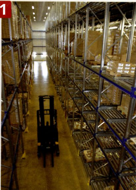
Palettier. Le stock de produits finis est divisé, pour l'instant, en deux parties : une moitié en stock de masse tampon et l'autre moitié en picking, effectué à chacun des quatre niveaux du palettier.
